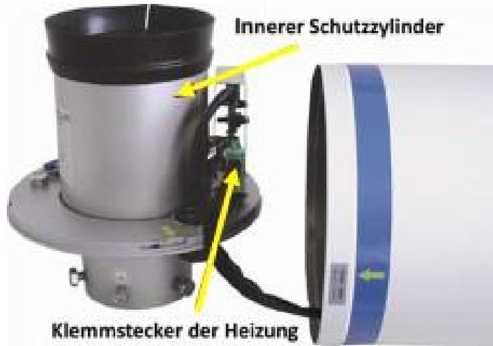
Abbildung 17: Zusammenbau des Rain[e] – Schritt 1
