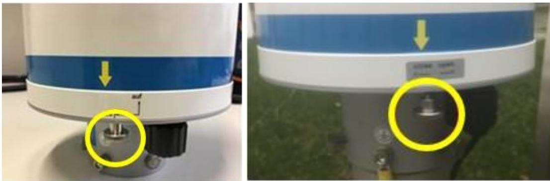
Abbildung 10: Rändelschraube Rain[e]
