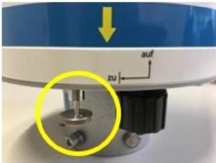
Abbildung 11: Lösen Rändelschraube
