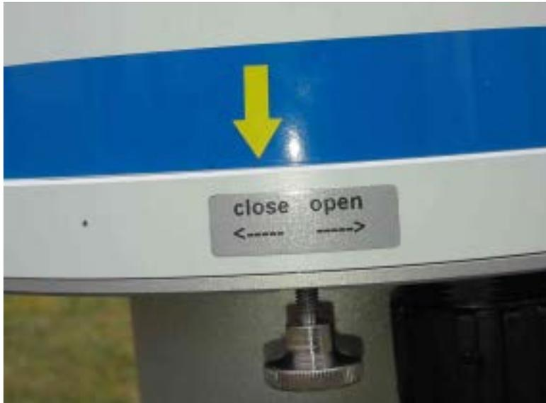
Abbildung 21: Zusammenbau des Rain[e] – korrektes Verschließen
