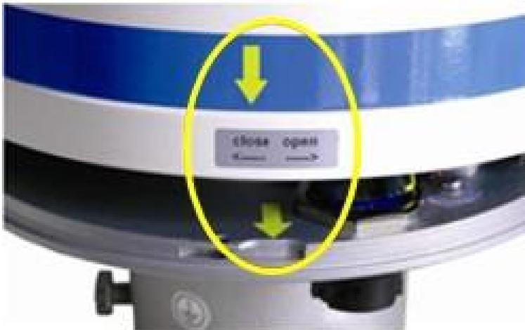
Abbildung 19: Zusammenbau des Rain[e] – Schritt 2
