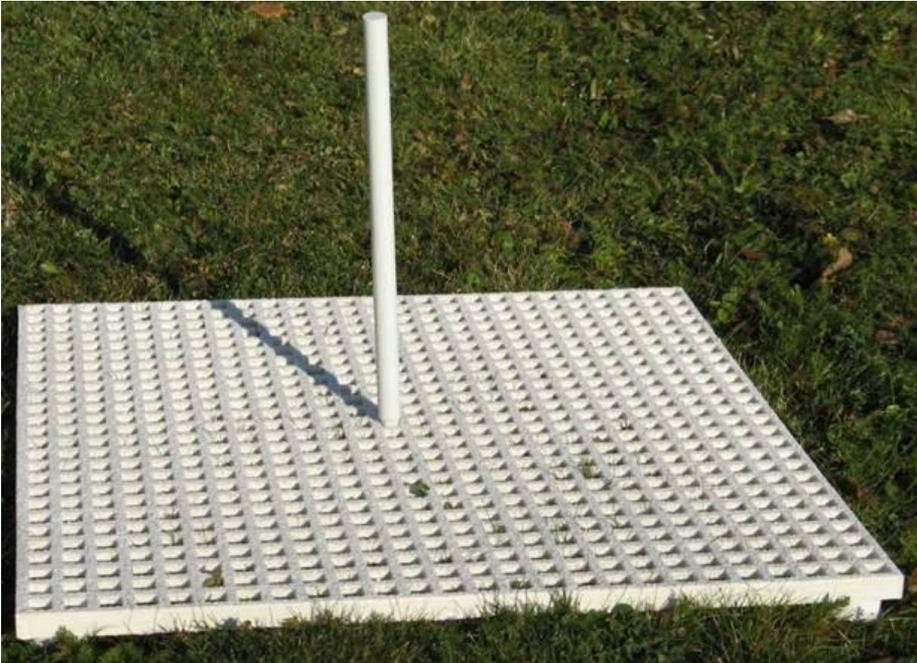
Abbildung 35 - DWD-Neuschneegitter mit Markierungsstab
