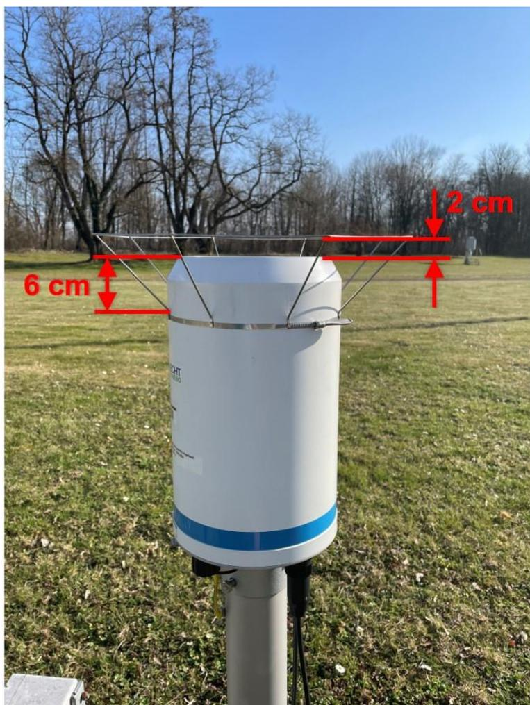
Abbildung 24: Höhe Befestigung Vogelschutzring
